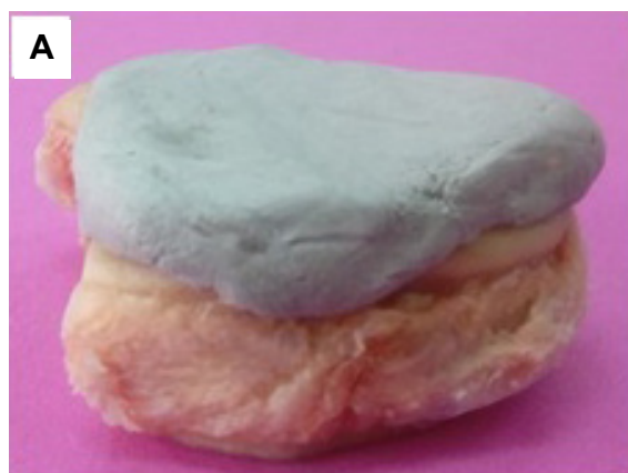
Figura 1. (A) Hueso carpo III con masilla previo al ensayo de compresión. (B) Ensayo de compresión con equipo servohidráulico AMSLER 6PZD 1406 ®
